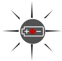
Ne procéder au chargement de l'accumulateur à température ambiante qu'au moyen du chargeur standard THEIS raccordé à la prise de chargement placée sous le laser. Un chargement sous +5°C peut entraîner des dommages à l'accu.
