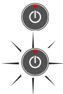
Falls der Stativkopf stärker als 5° geneigt ist, wird dies nach kurzer Zeit durch schnelles Blinken des Laserstrahls und der Nivellier - LED angezeigt.
