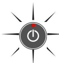
La LED de l'affichage de nivellement clignote. Une inclinaison de la tête du trépied supérieure à 5° est signalée après un court instant par un clignotement rapide du rayon laser et de la LED de nivellement. Lorsque l'opération de mise à l'horizontale est terminée, le rayon laser se met à tourner et la LED s'éteint.
